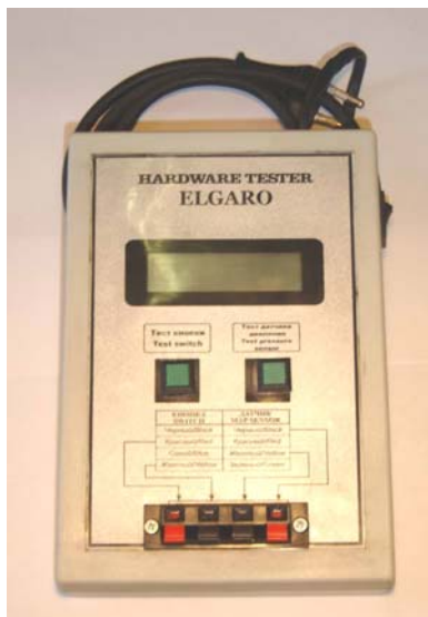
Рис. 14. Тестер датчика температуры и давления газа, а также тестер переключателя вида топлива
