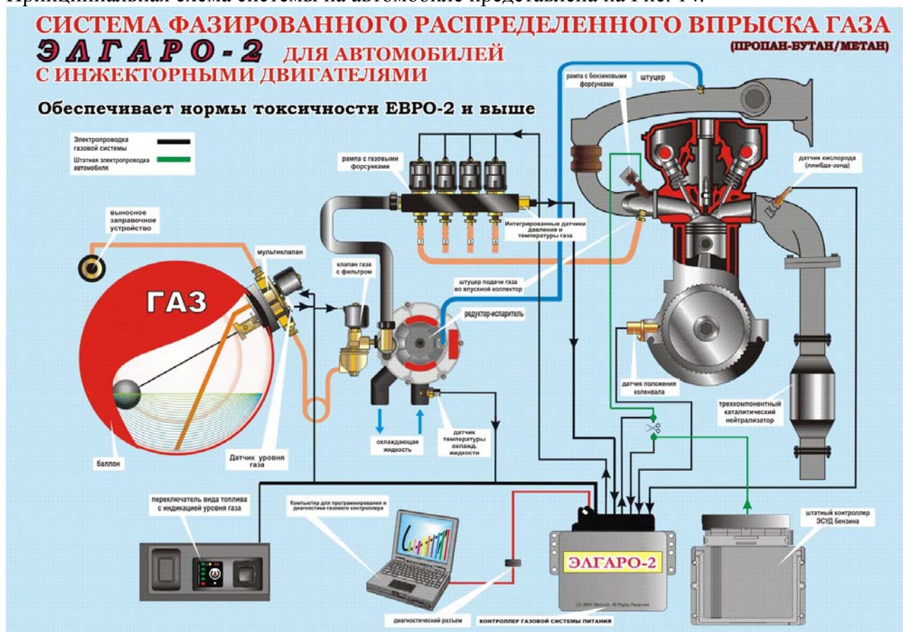
Рис. 14. Принципиальная схема системы на автомобиле.
